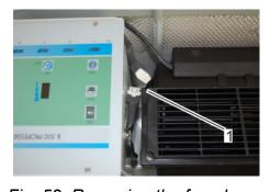
Fig. 52: Removing the fan plug
